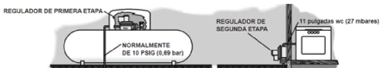
Figura N°. 9 Regulación de Doble Etapa.
