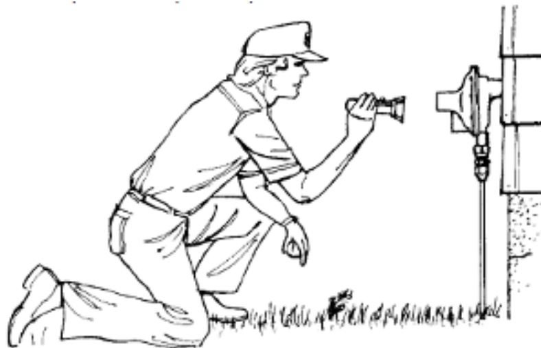
Figura N°. 13 Inspección interna del regulador para observar corrosión o impurezas
