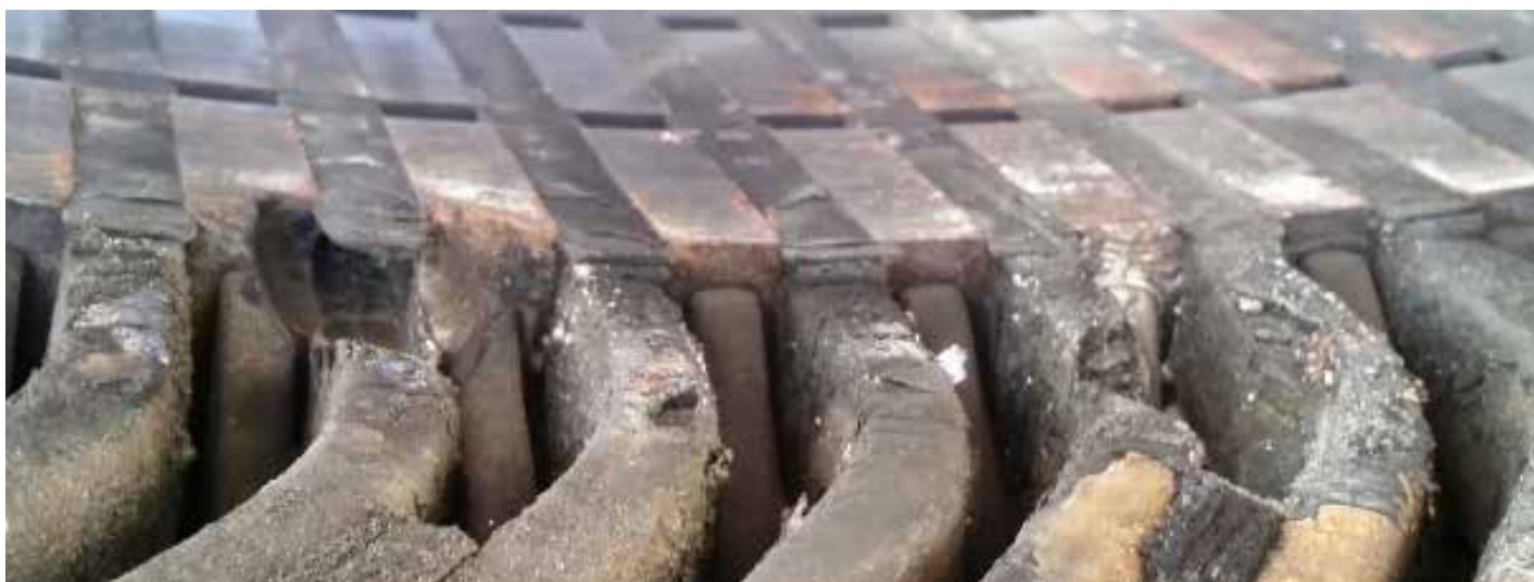
Figura 1. Detalle de una falla severa en un núcleo magnético
